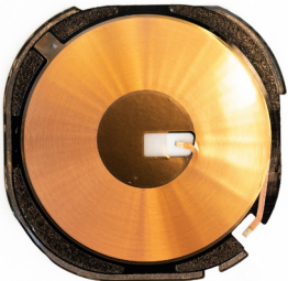
无线充电线圈 金 铜
