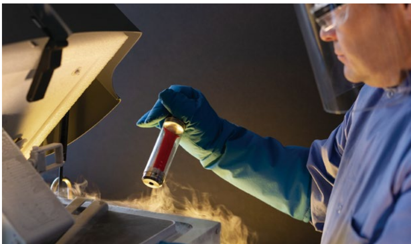
我们使用氮浴来分解 Apple Watch 运动型表带等产品的部件，测试其是否符合 Apple《受限制物质规范》
