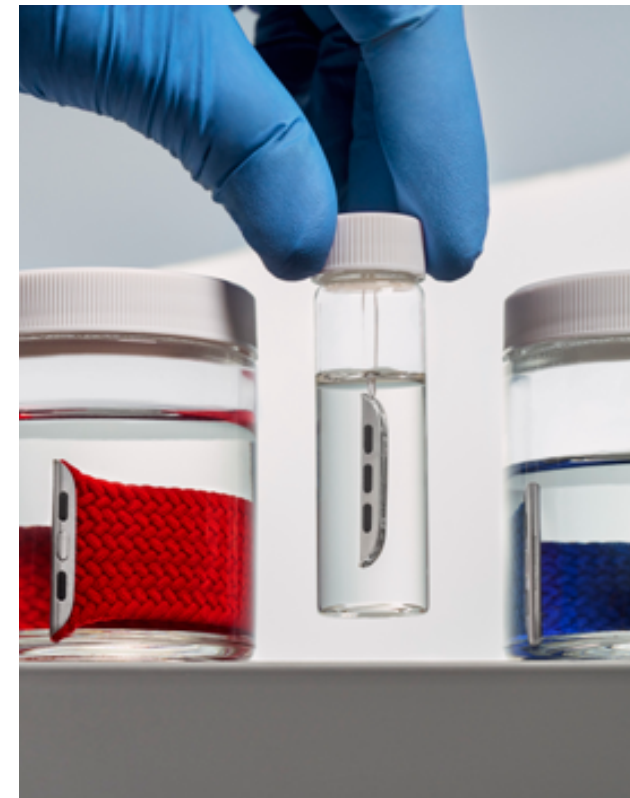
我们对各款产品都进行测试, 对长时间与皮肤接触的材料尤为关注, 在这项镍沥滤测试中, 我们将 Apple Watch 表带放入盛有人造汗液的罐子中, 以确保产品中的潜在致敏原镍不会发生转移
